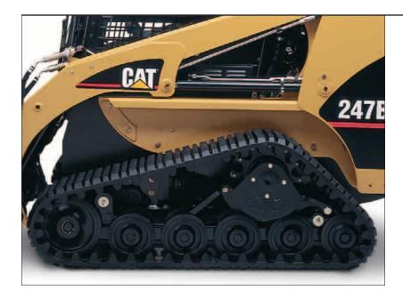
**Konstruktion.** Aus den 24 Aufstandspunkten der Leit- und Laufräder ergibt sich eine sehr gleichmäßige Gewichtsverteilung über die gesamte tragende Kettenlänge.
