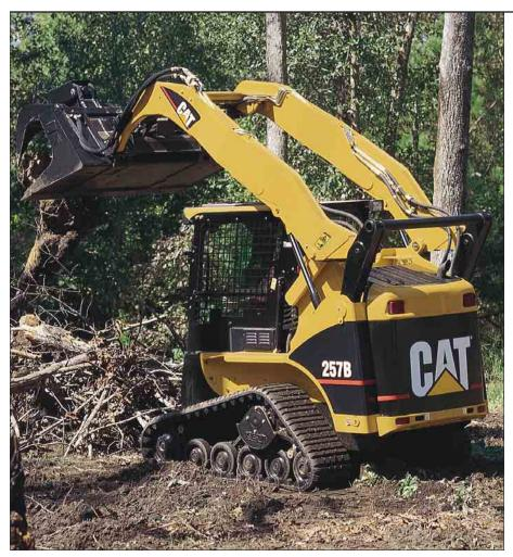
High-Flow-Hydraulik. Mit der als Sonderausrüstung für den 257B lieferbaren High-Flow-Hydraulik lassen sich hydraulische Anbaugeräte betreiben, die einen hohen Volumenstrom benötigen, zum Beispiel Asphalt-Betonfräsen, Grabenfräsen und Fugenfräsen.
