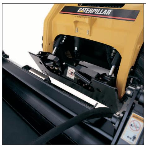
**Schnellwechsler.** Mit dem Schnellwechsler lassen sich unterschiedlichste Arbeitsgeräte rasch gegeneinander austauschen. Die wichtigsten technischen Merkmale des universellen Cat Schnellwechslers:
