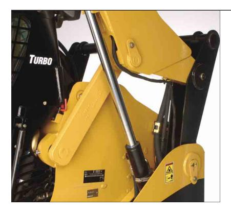
**Hubeinrichtung.** Die Hubeinrichtung mit Vertikalhubkinematik, die sich trotz des relativ geringen Eigengewichts durch eine robuste Bauweise auszeichnet, verhilft den Maschinen zu exzellenter Leistungsfähigkeit und beeindruckender Haltbarkeit.
