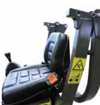
ROPS pieghevole per il trasporto facile
