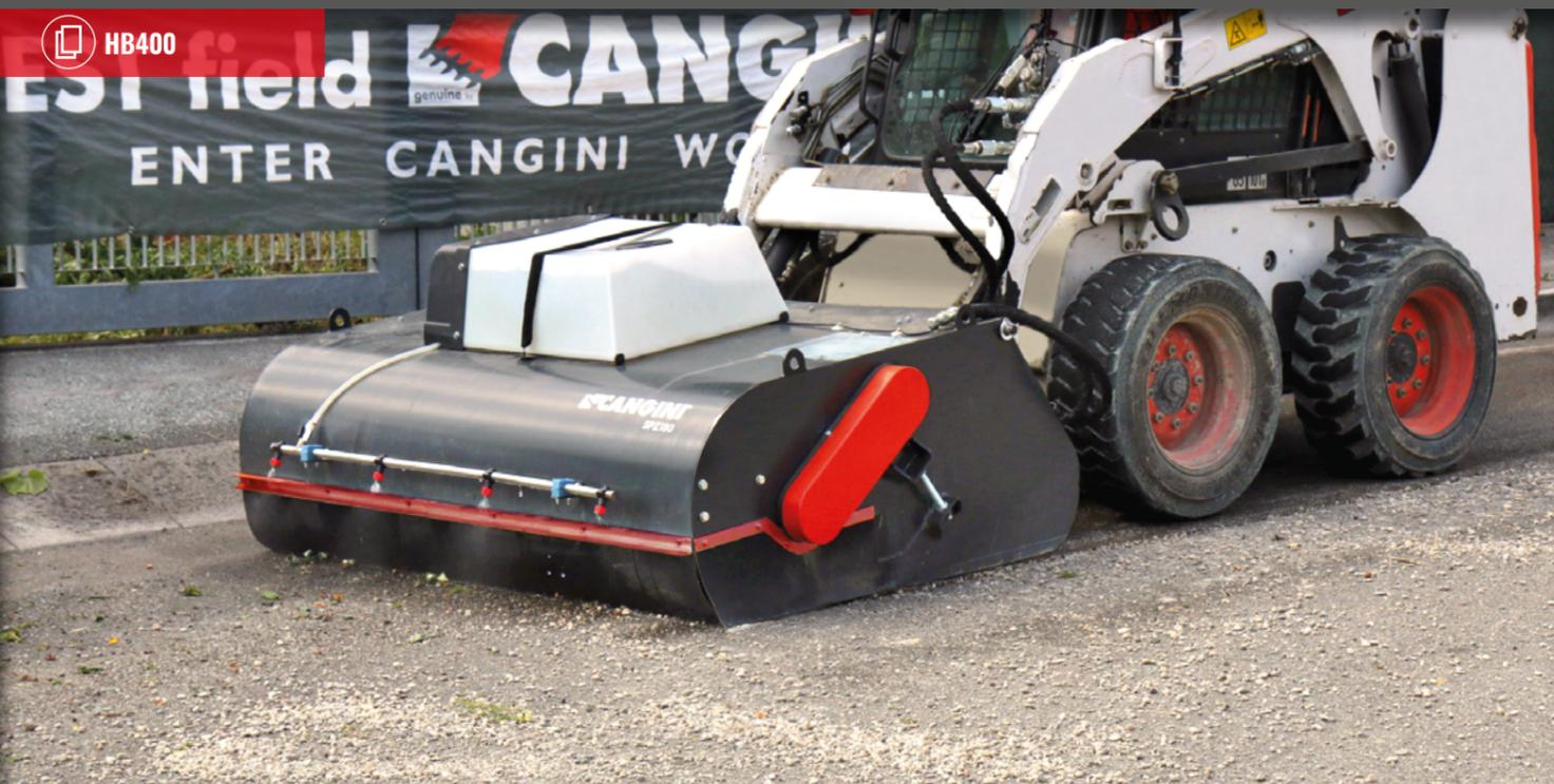
Particolarmente indicata per lavori gravosi. È dotata di vasca di raccolta con lama imbullonata e reversibile in HB400. Altezza rullo regolabile.
