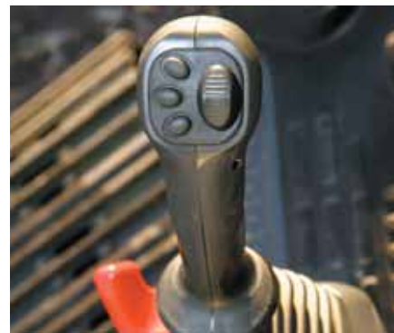
Manipolatori con comando proporzionale per gli accessori
