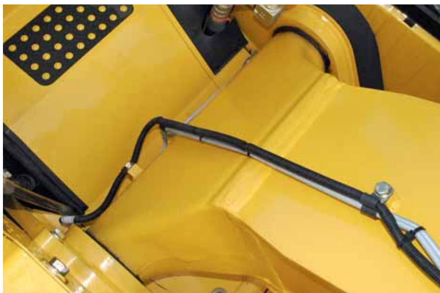
Base del braccio in fusione d'acciaio
