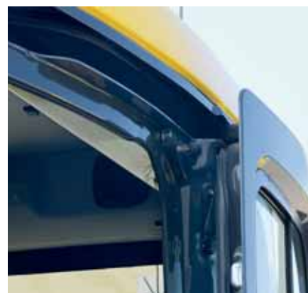
La porta scorrevole permette un accesso facile e rapido anche negli spazi più ristretti, e previene danni accidentali durante il lavoro e la movimentazione della macchina. La porta è dotata di un finestrino scorrevole.
