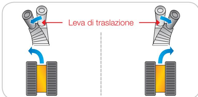
La macchina sterza secondo l'orientamento della leva.
