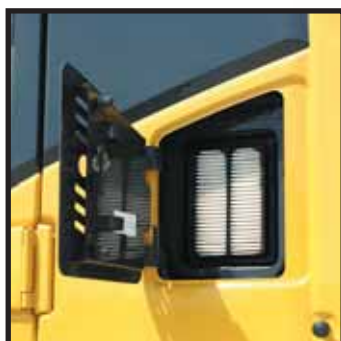
Filtro aria interno cabina La facile rimozione/ installazione dell'elemento del filtro aria interno cabina, senza necessità di attrezzi, semplifica le operazioni di pulizia
