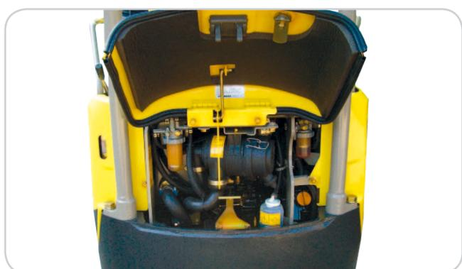
> Accesso facilitato a tutti i punti di manutenzione : organi motore, pompe idrauliche...
