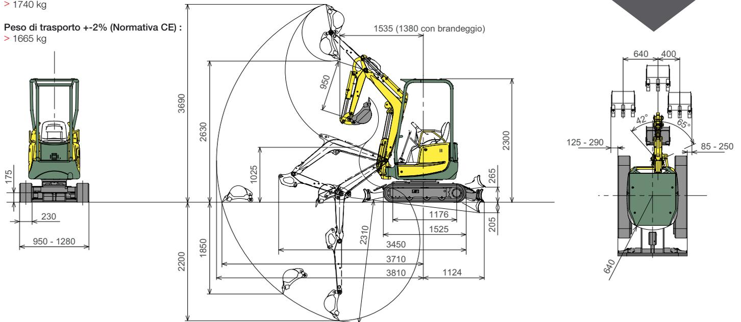
Con riserva di modifiche tecniche. Dimensioni in mm con benna standard Yanmar.
