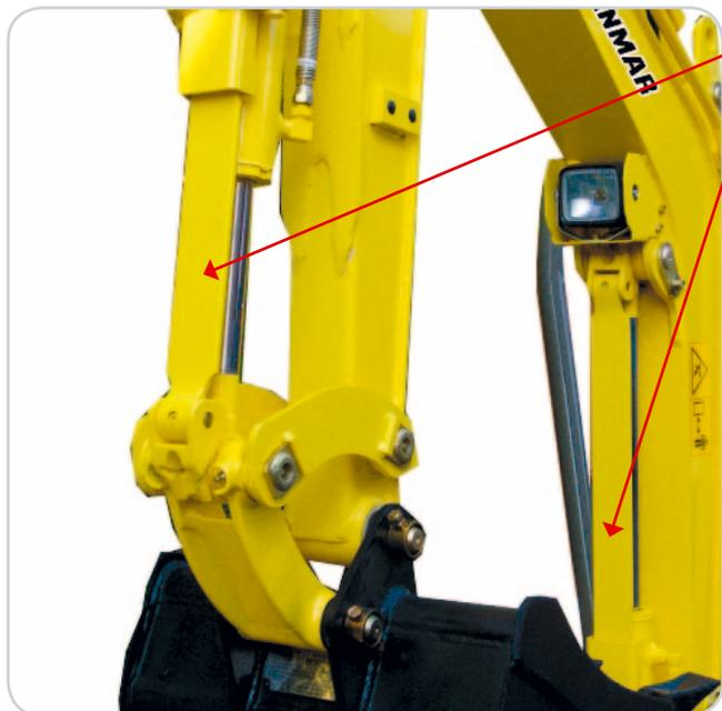
Tutti gli steli dei cilindri di lavoro sono completamente protetti da piastre di acciaio di grande elasticità.
