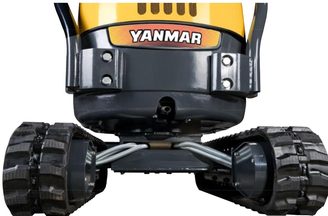
Il modello ViO12 ha un peso operativo di 1235 kg e il sottocarro più lungo della sua classe (1440 mm) con un conseguente miglioramento reale del comfort dell'operatore. L'operatore può avvalersi di una guida più regolare e migliorare la propria produttività.
